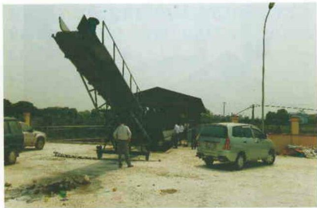
Hình 8. Thiết bị vớt rác tại trạm bơm Ngoại độ - Ứng Hòa - Hà Nội
